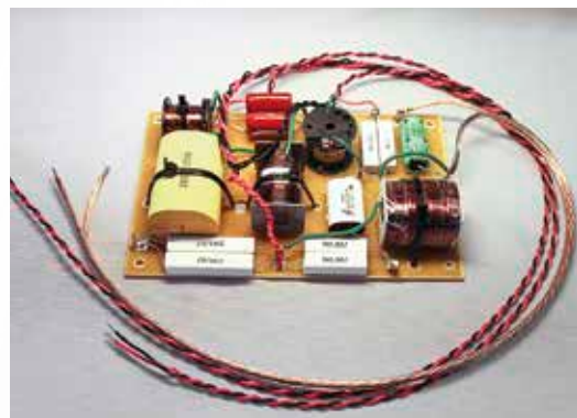
▲ Induktivitätsarm verdrillte Kabel und hochwertige, aber nicht exotische Bauteile zeichnen die Audes-Weiche aus.
